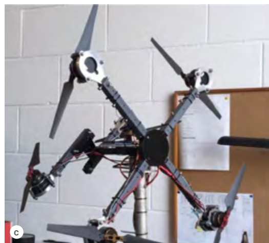
4. Photos de dispositifs expérimentaux utilisant différents types d'actionneurs mécaniques pour émuler la réponse du rotor lors d'essais en bassin. De gauche à droite : (a) câbles asservis [8], (b) turbine à air [9], (c) ensemble de propulseurs de drones aériens (figure originale de A. Otter et al. [10]).
